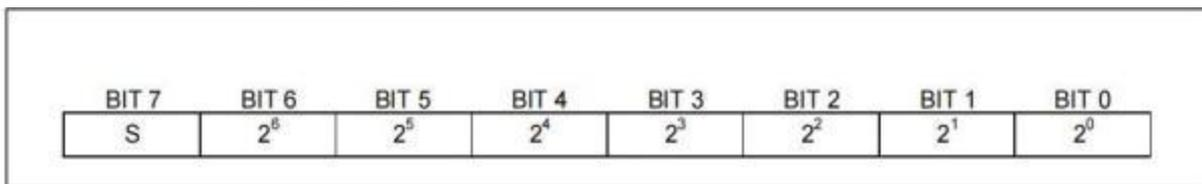
当 TH 和 TL 为 8 位寄存器时，在与 TH 和 TL 的比较中仅适用温度寄存器的 4 到 11 位。如果测得的温度高于 TH 或低于 TL，报警条件成立，18B20 内部就会置位一个报警标识。没进行一次测温就对这个标识进行一个更新。因此，如果报警状态消失，则在下一个温度转换后，该标识将被关闭。
