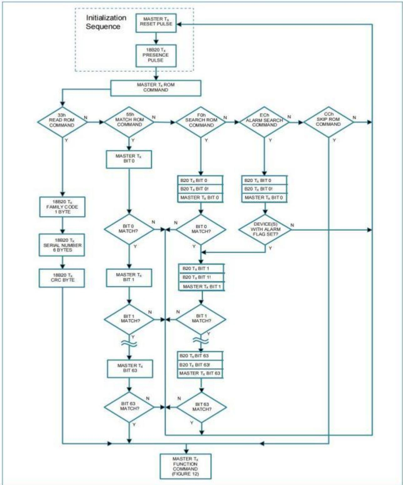
图 12.18B20 功能指令流程图
