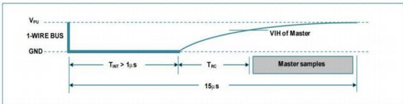
图 16. 推荐的控制度 1 时序
